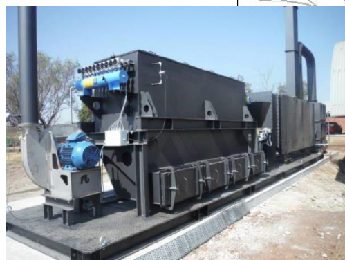
Exemplo de incinerador compacto
